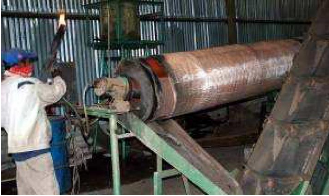
Gambar 20. Alat pengering pupuk organik menggunakan burner dengan bahan bakar solar
