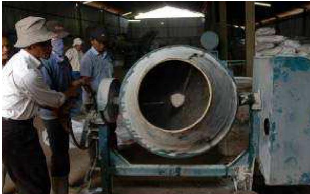
Gambar 18. Molen pengaduk semen untuk membuat pupuk granuler
