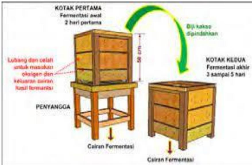
**Gambar 6.** Susunan Kotak Fermentasi
